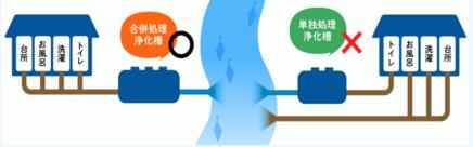
併処理浄化槽に転換すると、全ての生活排水を 処理する事ができるため、身近な水環境の改善 に大きな効果が期待できます。群馬県は首都圏の水源 地でありますが、汚水処理人口普及率\*は関東地区で 最下位であり、早急な生活排水対策が必要となっています。 みなし浄化槽から合併処理浄化槽への切り替えをお願いします。
