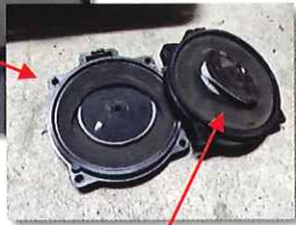
劣化した送風機の部品(ダイヤフラム) 定期的な交換が必要です。
